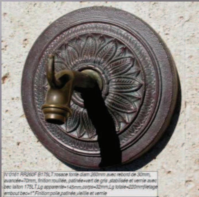
N°0161 RR260F B175LT :rosace fonte diam 260mm avec rebord de 30mm, avancée=70mm, finition:rouillée, patinée+vert de gris ,stabilisée et vernie avec bec laiton 175LT,Lg apparente=145mm,corps=32mm,Lg totale=220mm/filetage embout bec=1" Finition:polie,patinée, vieillie et vernie
