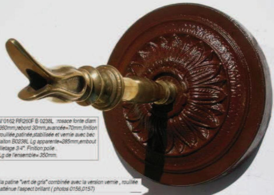
N°0162 RR260F B 0238L :rosace fonte diam 260mm,rebord 30mm,avancée=70mm,finition rouillée,patinée, stabilisée et vernie avec bec laiton B0238L Lg apparente=285mm,embout filetage 3/4" Finition:polie Lg de l'ensemble= 350mm.
