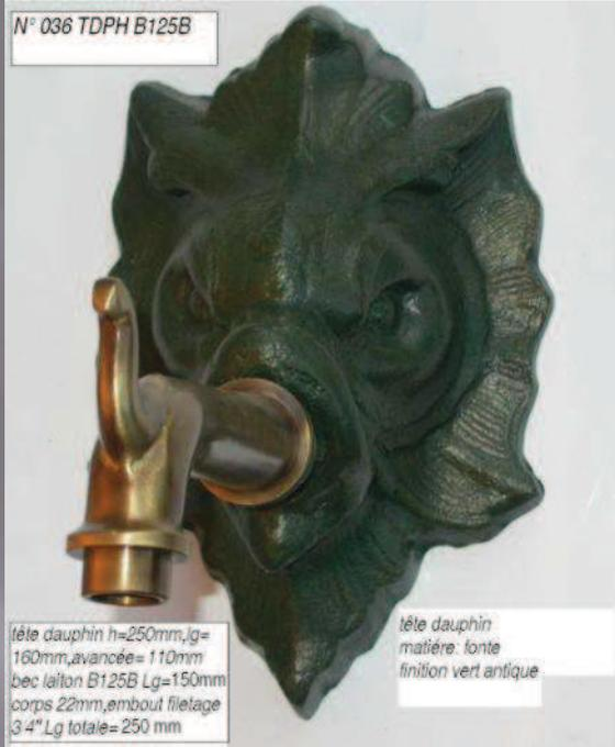
tête dauphin h=250mm,lg= 160mm,avancée= 110mm bec laiton B125B Lg=150mm corps 22mm,embout filetage 3/4" Lg totale=250 mm
