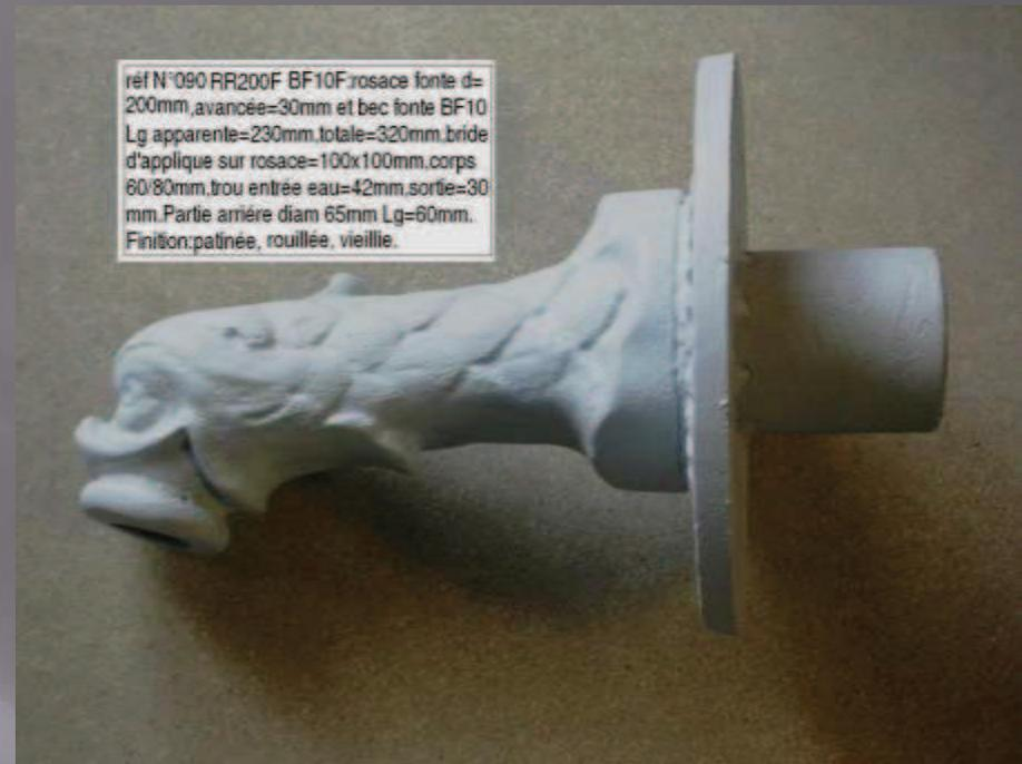
réf N°090 RR200F BF10F:rosace fonte d=200mm,avancée=30mm et bec fonte BF10 Lg apparente=230mm,totale=320mm,bride d'applique sur rosace=100x100mm,corps 60/80mm,trou entrée eau=42mm,sortie=30 mm.Partie arrière diam 65mm Lg=60mm. Finition:patinée, rouillée, vieille.
